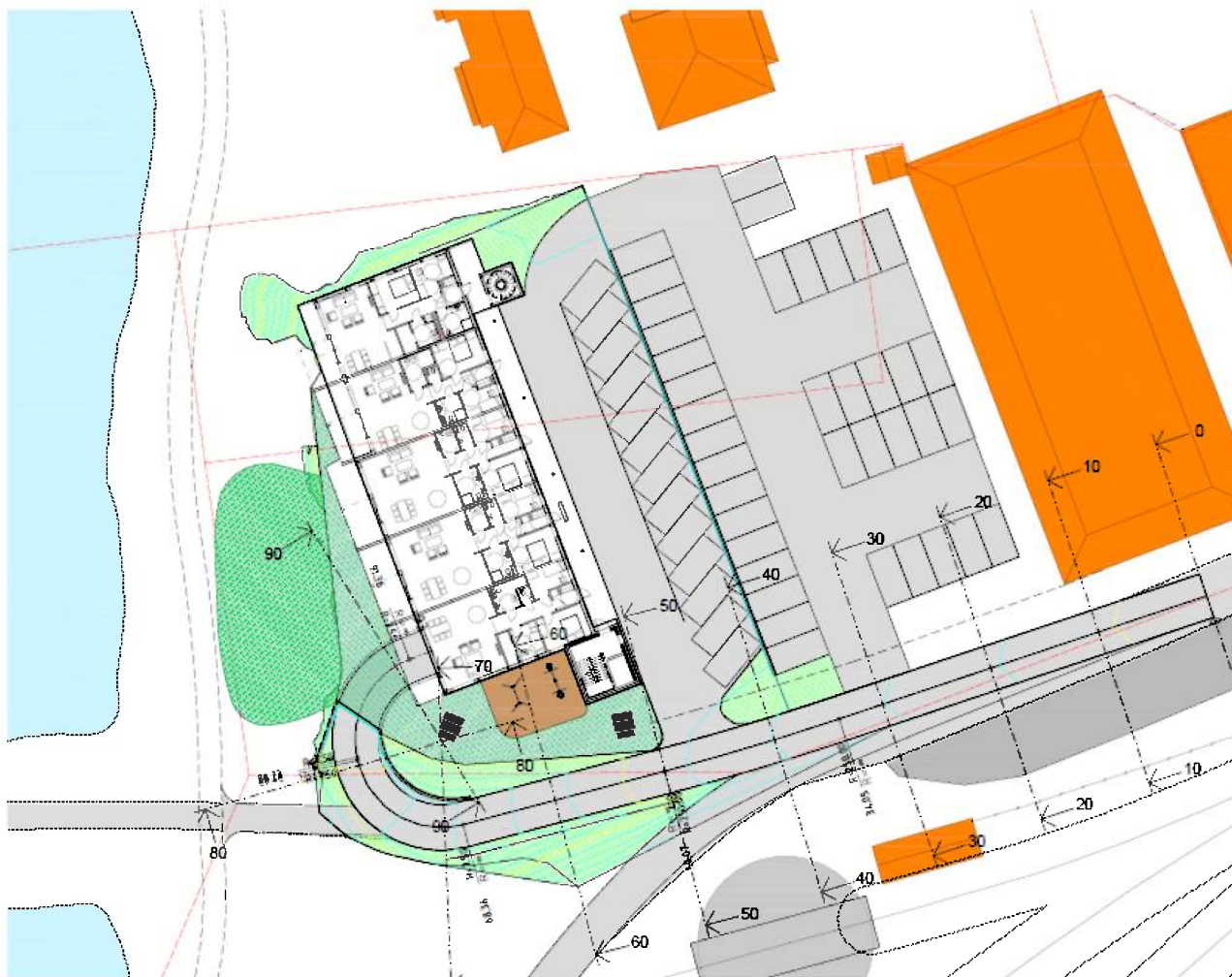
Utsnitt 5: Situasjonsplan som viser snitt og teoretisk beregnet skråningsutslag på atkomstvegen.
