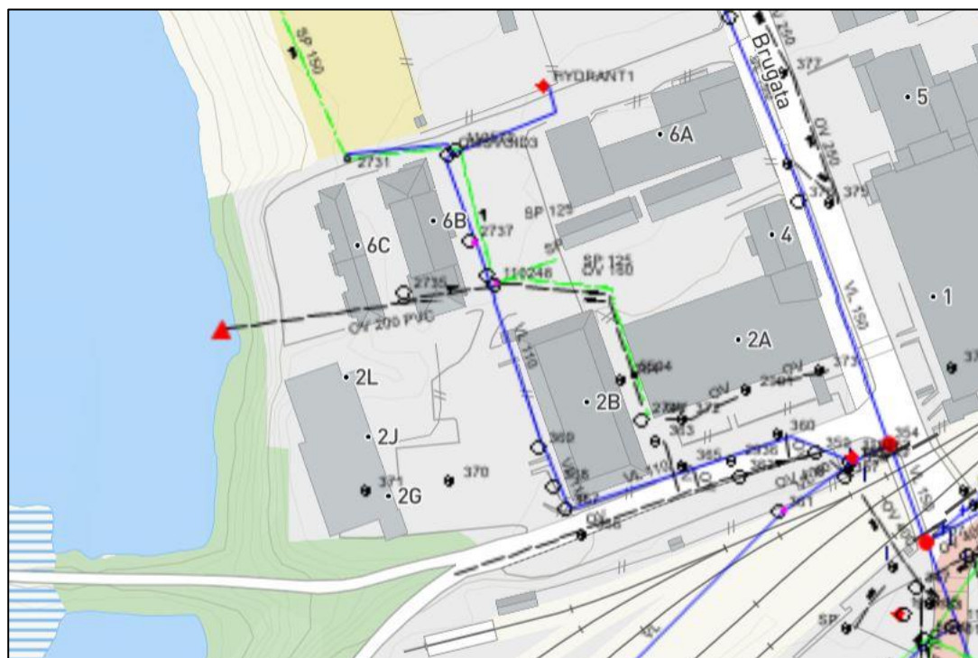
Figur 4-18 – Overvannsledning (fra Brugata) med utløp til Tjønnområdet
