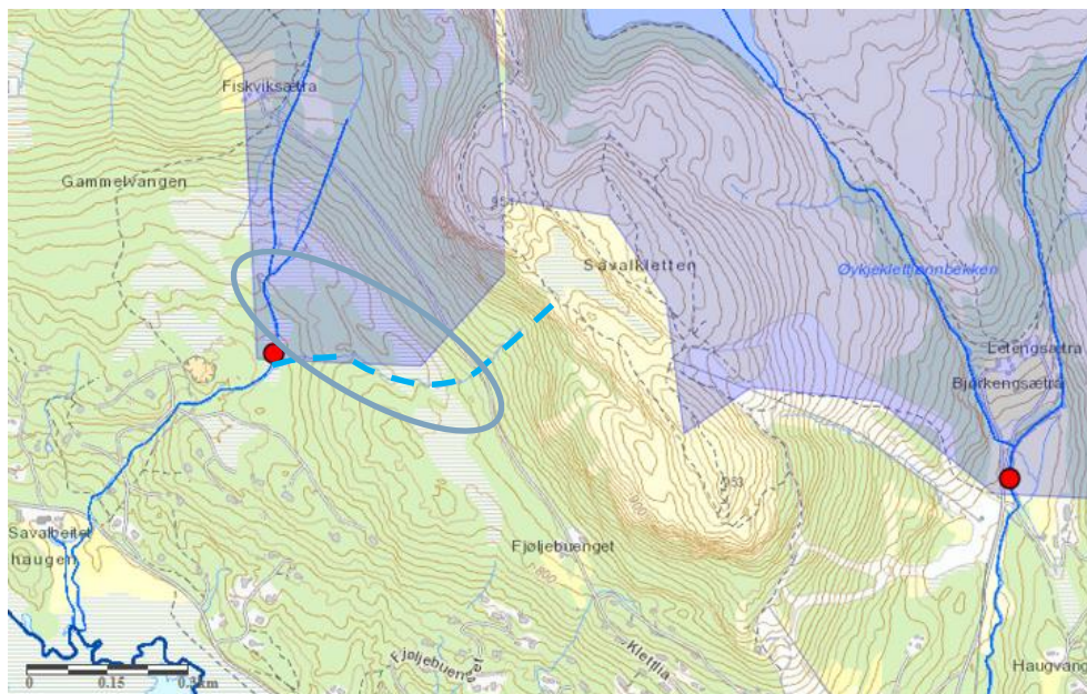
Figur 8: Bekkeløpet som går gjennom vurdert område (sirkel, omtrentlig plassert) er markert med blå stiplet linje. Bekken er for liten til å få generert nedbørsfelt i NEVINA. Nedbørsfelt for to nærliggende bekker er estimert i NEVINA, NVE [5].
