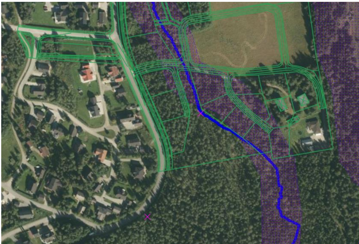
Figur 5: Rosa kryss viser inn- og utløp av det Ø300 mm overvannsrøret som fører overvann inn i Myrvollbekken.
