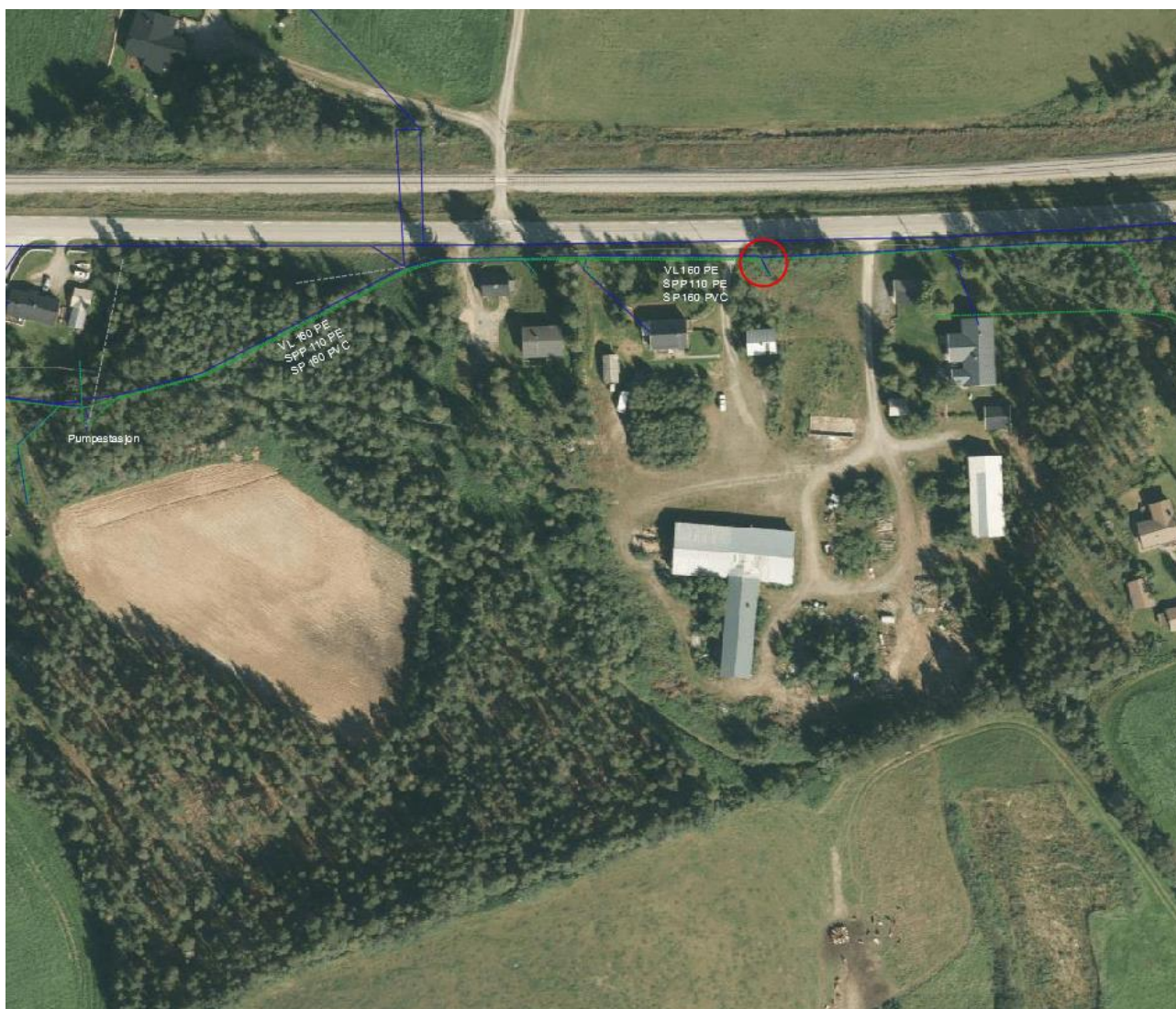
Figur 3. Oversikt over eksisterende kommunal VA-infrastruktur i området. Kumgruppe hvor det er lagt ut ledninger for tilknytning av planområdet er markert med rød sirkel. Skjermbilde fra prosjekteringsprogramvare AutoCad.
