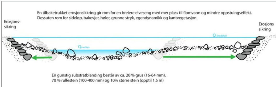
Figur 3. Eksempelskisse med tverrsnitt som viser tilbaketrukket erosjonssikring (kilde: Plug, et al., 2017).
